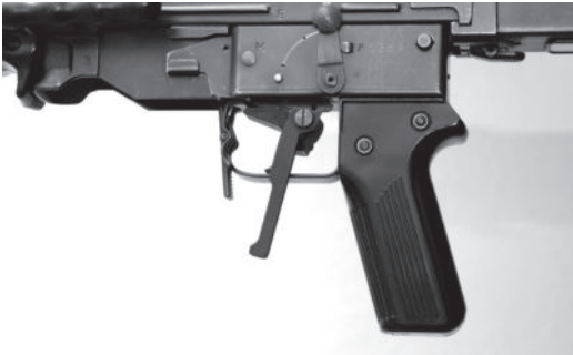
Bild 33: Winterabzug für Linksschützen zu Stgw 57
