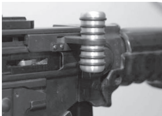
Bild 34: Poignée de charge anatomique pour F ass 57
