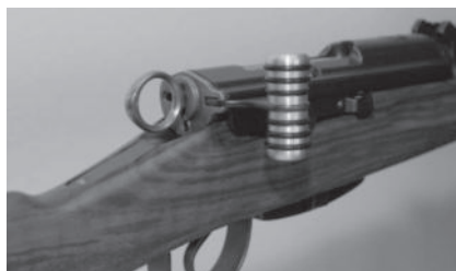
Figure 39: Poignée de verrou anatomique pour mousqueton et fusil
