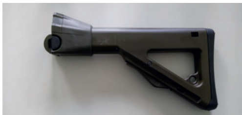
Bild 16: Verstellbarer Kolben zu Stgw 90
