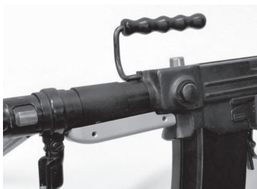
Figura 32: Paramano del F ass 57
