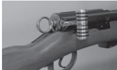
Bild 39: Riegelgriff anatomisch zu Karabiner und Langgewehr
