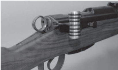
Bild 39: Riegelgriff anatomisch zu Karabiner und Langgewehr
