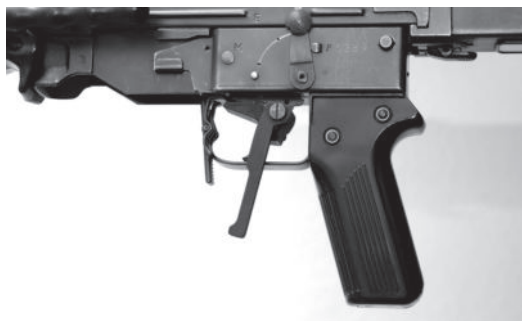
Figura 33: grilletto ausiliario d'inverno per F ass 57
