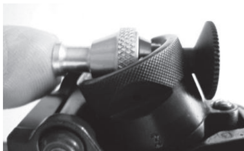
Figura 8: sistema di filtri colorati Wyss innestabile
