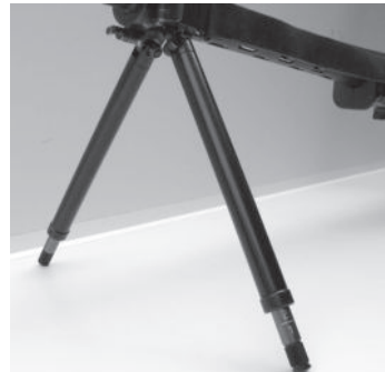
Bild 3: Verstellbare Zweibeinstütze zu Stgw 57, diverse Fabrikate
