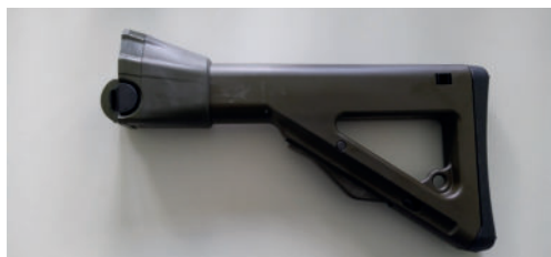
Figure 16: Crosse réglable pour F ass 90
