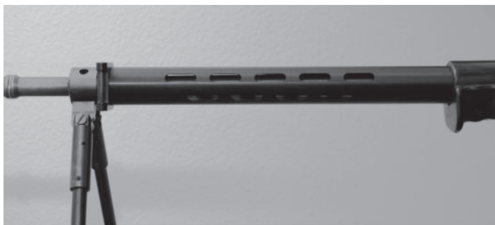
Bild 31: Mantelrohr zu Stgw 57
