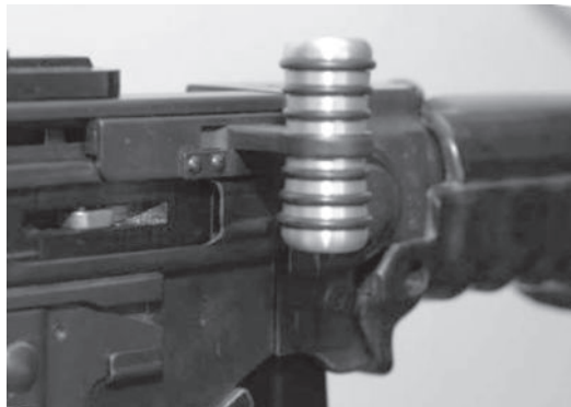
Figura 34: leva d'armamento anatomica per F ass 57
