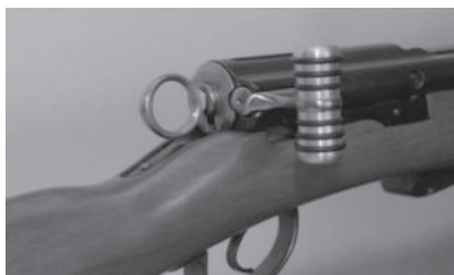
Figure 39: Poignée de verrou anatomique pour mousqueton et fusil
