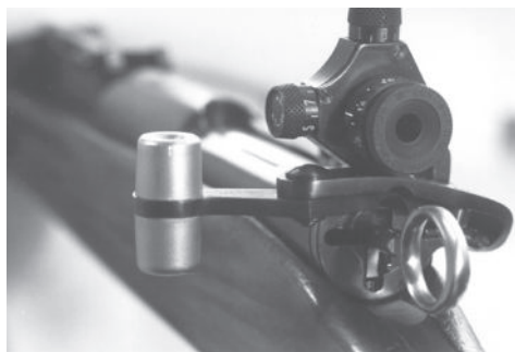
Figure 37: Verrou à gauche pour mousqueton 31
